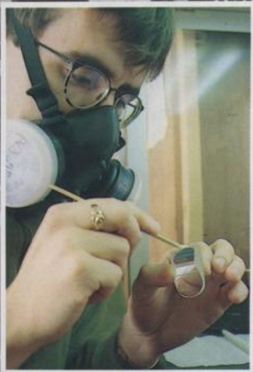
Pirkearbeide; rensing av prismene til en OP-kikkert.
